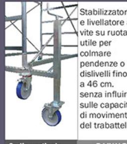
Stabilizzatore e livellatore a vite su ruota, utile per colmare pendenze o dislivelli fino a 46 cm. senza influire sulle capacità di movimento del trabattello
