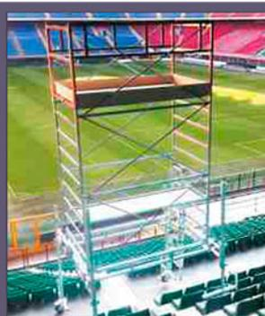
Base GIGANTE con grande capacità di regolazione. Realizzata in acciaio zincato tralicciata, regolabile in larghezza e provvista di n° 4 grandi livellatori regolabili in altezza capaci di compensare dislivelli fino a mt. 1,5. e di n° 4 stabilizzatori a vite. Ideata per un utilizzo su gradinate stadi o su poltrone cinema multisala.
