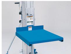
Piattaforma di carico: si installa facilmente su forche standard o regolabili senza l'uso di attrezzi. Di grande utilità per il carico e scarico di oggetti pesanti.
