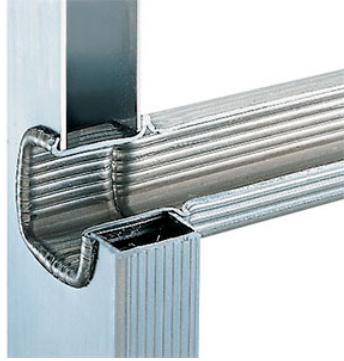
particolare piolo 30 x 30 antiscivolo con doppia bordatura
