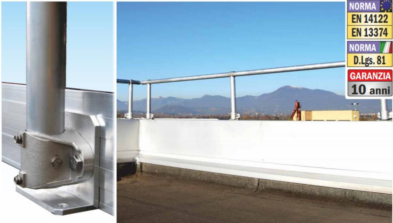
Disponibili in versione dritta, e inclinata, vengono fissati alla struttura con tasselli meccanici dimensionati appositamente o con barre filettate in resina chimica bi-componente. La piastra di aggancio dritta consente di installare parapetti su una superficie piana.
