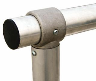
Assemblaggio del telaio parapetto mediante giunzioni in fusione di alluminio che consentono i cambi di direzione o di quota.
